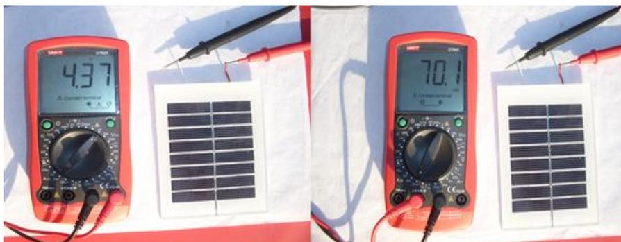
Figura 51: Potência disponibilizada pelo painel solar tensão (esquerda) e corrente (direita).
